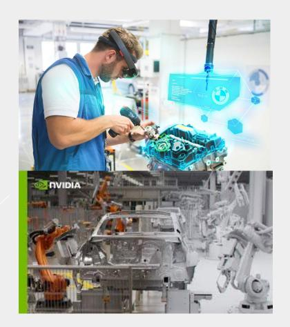
La simulación de procesos (process simulation) es una técnica que emplea herramientas informáticas para desarrollar gemelos digitales. Consisten en aplicaciones digitales que imitan el comportamiento y el rendimiento de un sistema del mundo real, por ejemplo, una línea de producción industrial o un proceso de manejo de mercancías en un almacén. El objetivo consiste en analizar el funcionamiento del sistema y optimizarlo.
